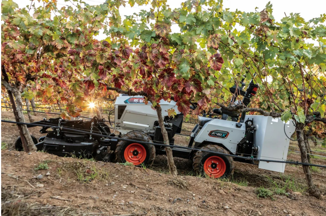
Der batteriebetriebene AT450X kombiniere den knickgelenkten Traktor von Bobcat mit der Software und der eingebetteten Computertechnologie von Agtonomy. (Foto: Screenshot Social Media)
