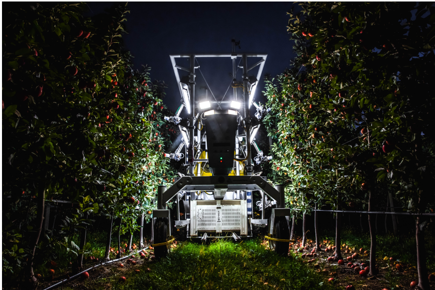
Das System von Advanced Farm Technologies nutze Computer Vision und maschinelles Lernen, um die besten Früchte zu pflücken, entweder tagsüber oder nachts, und sie dabei schonend zu behandeln, um Druckstellen und Schäden zu vermeiden. (Foto: Werkbild)
