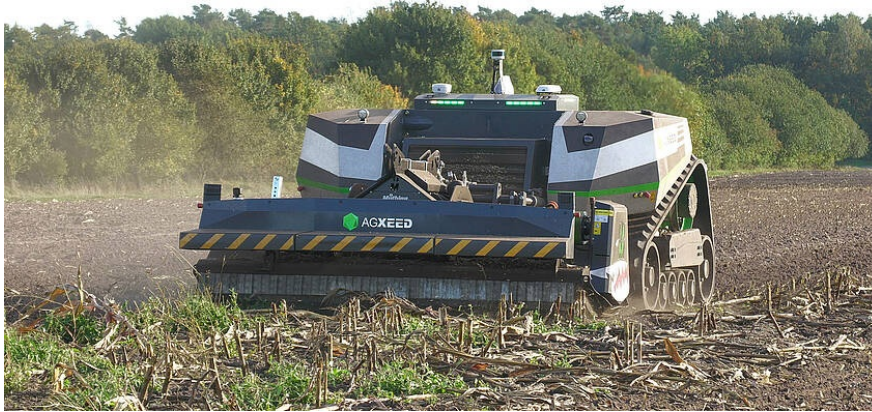
Der AgBot mit dem Mühling E-Vario-Shark im Einsatz – ein elektrifizierter Mulcher, der dank Sensorik Störungen erkenne und über die 3A Schnittstelle mit dem AgBot oder dem mit einer AgXceed Box ausgerüsteten Traktor kommuniziere. (Foto: Werkbild)
