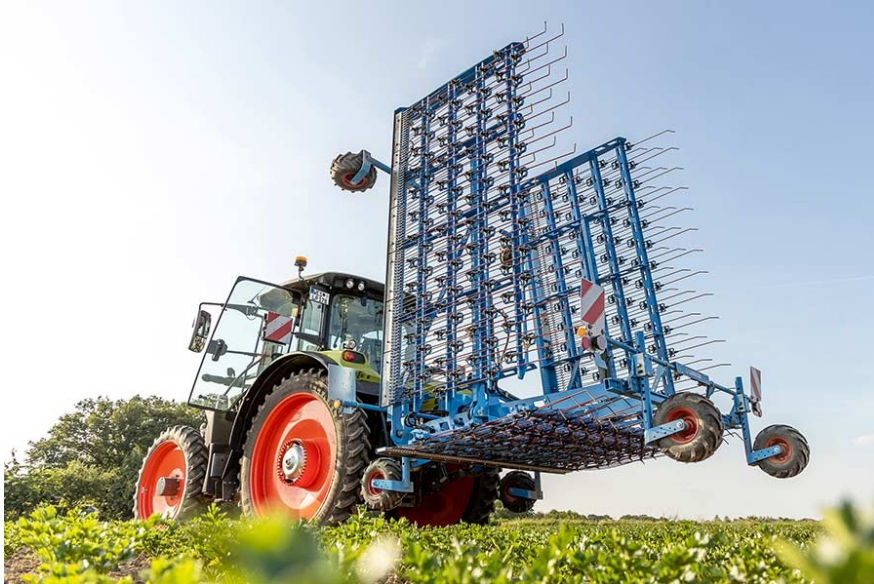
Bei dem Striegel Thulit von Lemken sind die Zinken in einem Strichabstand von 31,25 mm an vier Balken in acht Reihen angeordnet. Mit 6 und 9 m Arbeitsbreite seien die Striegel in begrenzter Stückzahl zur Saison 2024 verfügbar. (Foto: Werkbild)
