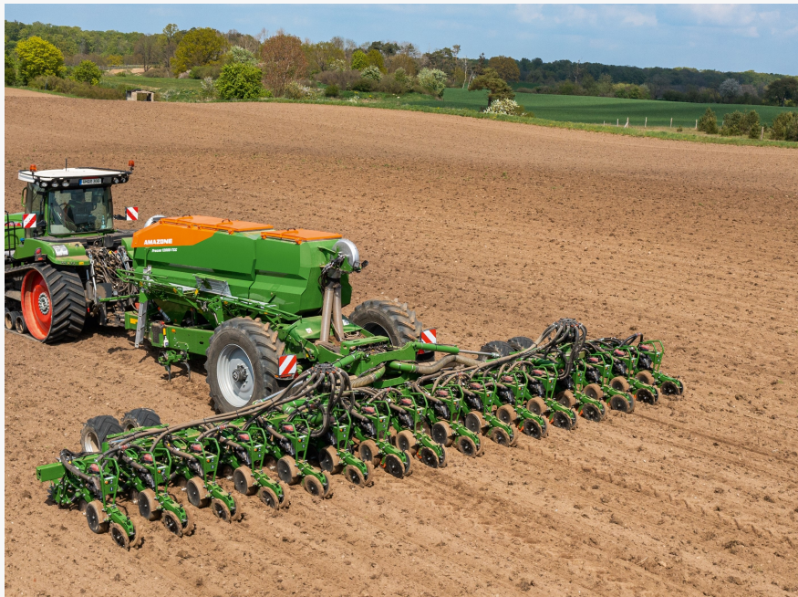
Amazone hat jetzt das Programm der Einzelkorn-Sätechnik um die gezogenen Produkttypen Precea 9000-TCC und 12000-TCC mit 9 und 12 m Arbeitsbreite erweitert. (Foto: Werkbild)
