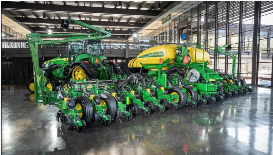
Der hochautomatisierte 8RX-Traktor von John Deere und eine 16-reihige 60-Fuß-Sämaschine arbeiten mit mehr als 300 Sensoren und 140 Steuergeräten, die 15.000 Messungen pro Sekunde pro Maschine verarbeiten. (Foto: Werkbild)
