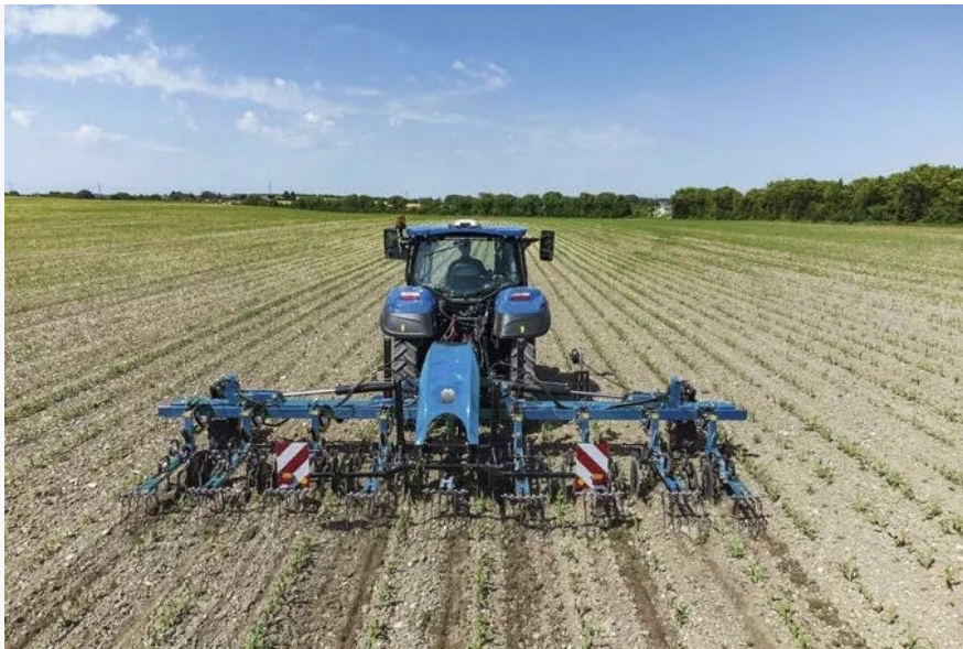
Die «SRC SmartSteer»-Hackgeräteproduktfamilie von New Holland mit dem Kameraspurführungssystem VSN von Raven umfasse acht Modelle mit 8 bis 18 Reihen, die in den zwei Rahmenbreiten 6,70 m und 9,90 m erhältlich seien. Zur Auswahl stünden die Reihenabstände 45 cm, 50 cm, 60 cm und 75 cm. (Fotos: Werkbilder)
